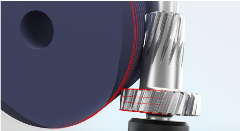
Die Limite beim Wälzschleifen: Illustration eines störkonturbehafteten Bauteils bei Bearbeitung durch Wälzschnecken mit Standard-Durchmesser
