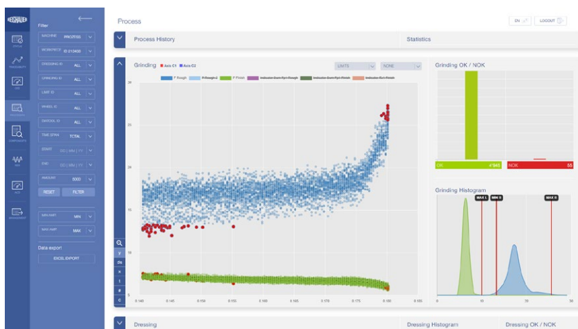
Abbildung 4: Härtevariation über die Schleifschneckenbreite
