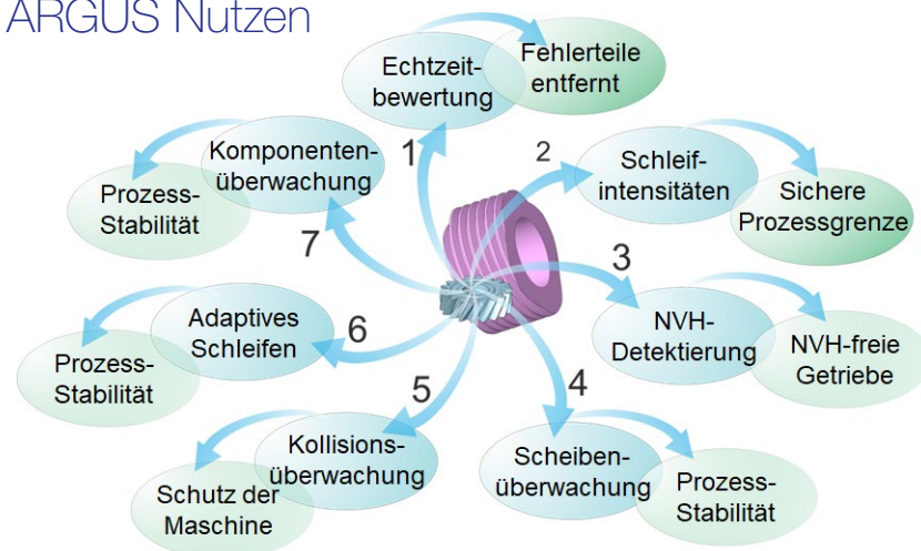
Abbildung 2: Elemente und Nutzend des Prozessüberwachungssystems
