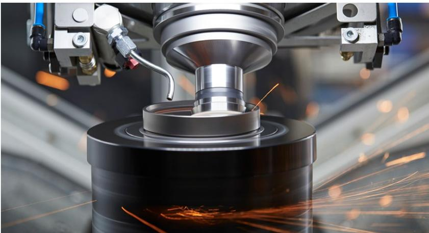
Mit allen sechs als Regelachsen ausgeführten Achsen erlaubt die RS 300 hohe Freiheitsgrade bei der Modifizierung der Zahnflankentopologie. Dadurch lässt sich die Verschränkung der Zahnflanken gezielt beeinflussen (Twist Control), ohne die Zykluszeit wesentlich zu verändern.
