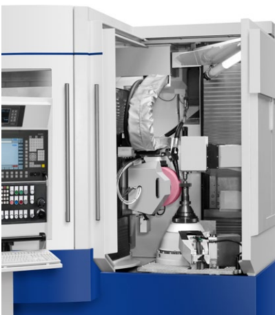
最优化的操作空间布局：磨削位置、砂轮更换位置、修形位置
