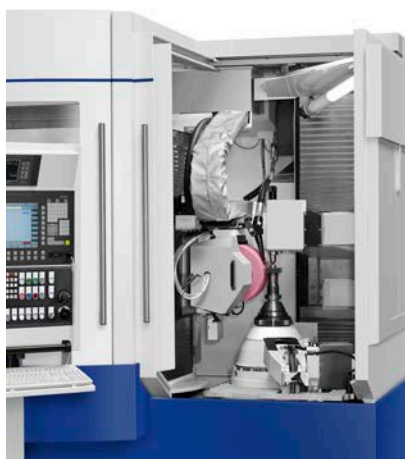
最適なアクセス性 研削位置、砥石交換位置、ドレス位置
