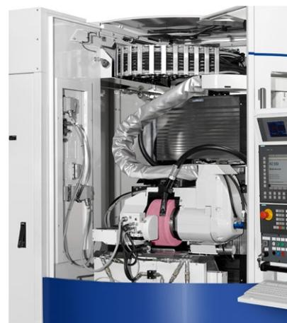
Optimal zugänglich: Schleifposition, Wechselposition, Abrichtposition
