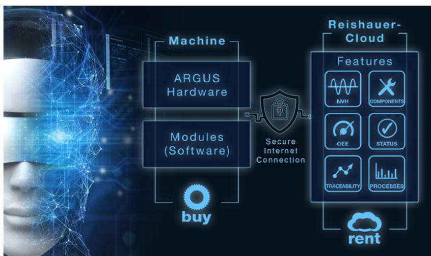
ARGUSモニタリングシステムは、ハードウェアコンポーネント、機械側ソフトウェア（モジュール）、および Reishauer Cloudに接続したユーザーが利用できるデジタル製品（機能）で構成されています。モジュールの機能は、研削盤で行われるすべての加工プロセスの解析と評価に重点を置いています。その目的は、安定したドレスと研削品質により、プロセスの安定性と生産性を向上させることです。クラウド機能により、接続されているすべての研削盤について、その完全な履歴を含む正確な画像をリアルタイムで作成できます。非常に革新的なNVH関連機能は、ギヤとトランスミッションの生産をより身近なものにします。
