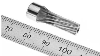
Die Profilschleifköpfe PSK erweitern die Anwendungsmöglichkeiten der Reishauer Wälzschleifmaschinen. Sie ermöglichen das Schleifen von Zahnrädern mit sehr kleinem Modul und Durchmesser, wenn diese Störkonturen aufweisen.
