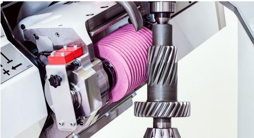
Das Upgrade-Modul für die Reishauer RZ 410 bis RZ 1000 nutzt eine im Durchmesser auf 140 mm ( $d_{rmin}$  67 mm) reduzierte Korund-Schleifschnecke, womit die Vorteile des Wälzschleifverfahrens für erweiterte Anwendungen nutzbar gemacht werden. Sie füllt damit die Lücke zwischen unseren hochproduktiven Doppelspindelmodellen RZ 126/160 KWS 4.0 und dem Profilschleifverfahren.
