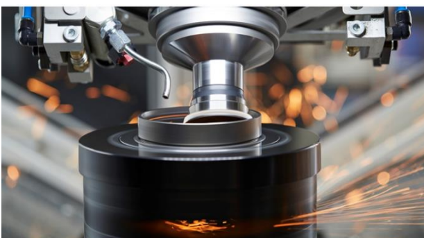
Abbildung 5: Hartwälzschälen einer Innenverzahnung auf der RZW300 4.0 der Firma Reishauer.
