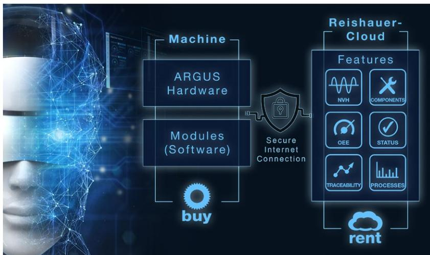
Das ARGUS Monitoring System besteht aus Hardwarekomponenten und maschinenseitiger Software (Module), sowie aus digitalen Produkten (Features), welche auf der Reishauer-Cloud zur Verfügung stehen. Die Funktionalitäten der Module fokussieren sich auf die Analyse und Bewertung von sämtlichen Bearbeitungsprozessen auf der Schleifmaschine.
